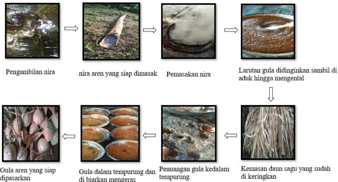
Gambar 2. Proses Produksi Gula Aren
