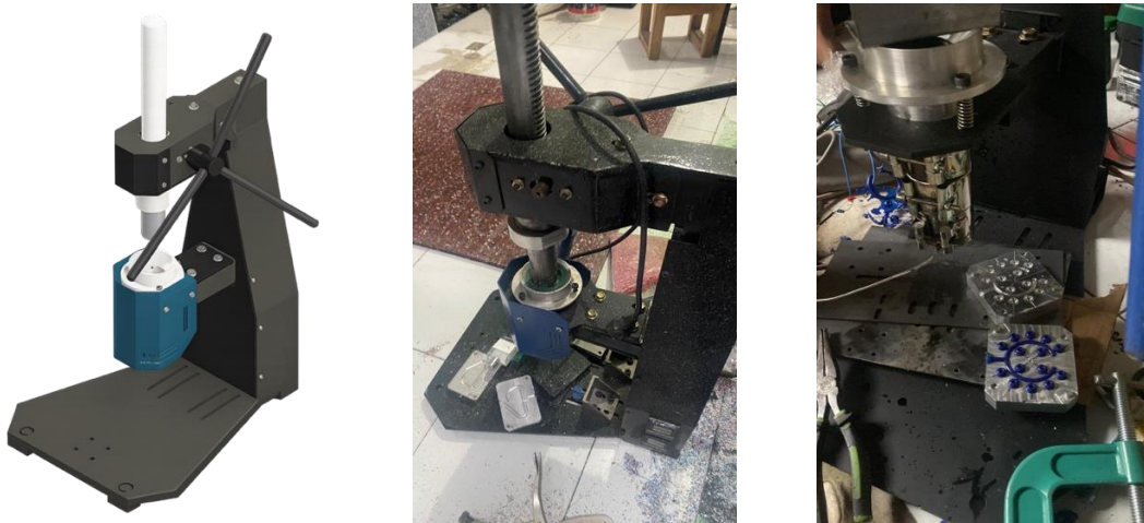
Gambar 4. Desain dan Pengoperasian Mesin Injeksi Plastik Manual
