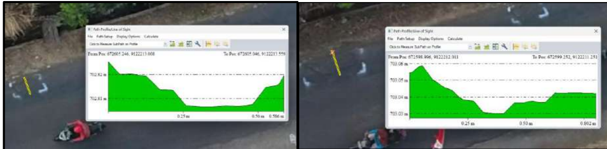
Gambar 6. Pengukuran kedalaman kerusakan jalan jenis lubang dari data DEM.
