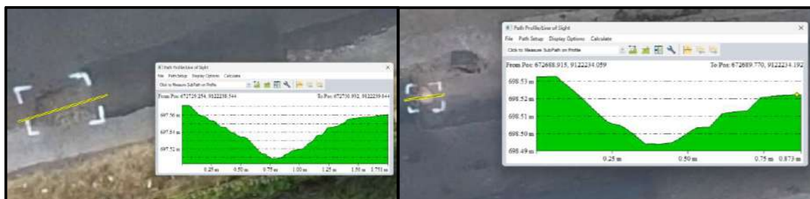
Gambar 5. Interpretasi visual kerusakan jalan jenis lubang.
