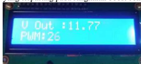
Gambar 6. LCD yang menampilkan tegangan keluaran realtime dari Boost Converter dan nilai PWM yang dikeluarkan Arduino
