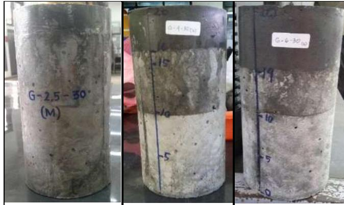
Gambar 2. Visualisasi Mortar Geopolimer yang Melapisi Beton
