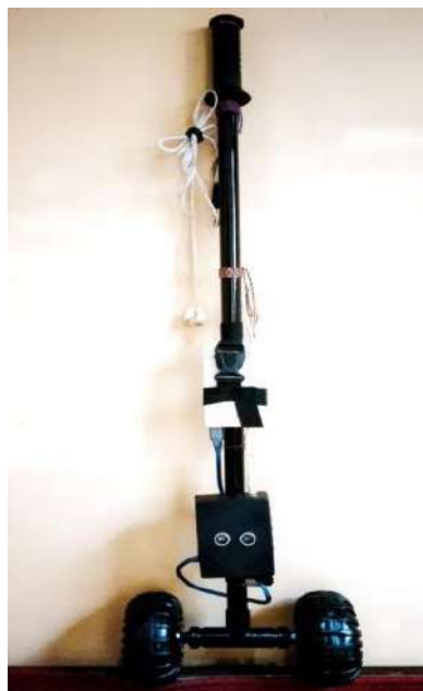
Gambar 16 Alat Bantu Navigasi Tuna Netra Berbasis Arduino dengan Sensor Ultrasonik
