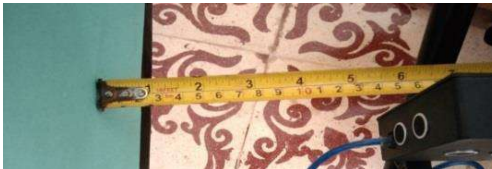
Gambar 10 Pengujian sensor kanan jarak 15 cm
