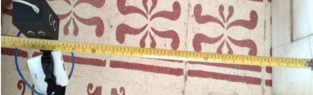
Gambar 15 Pengujian sensor kiri jarak 70 cm
