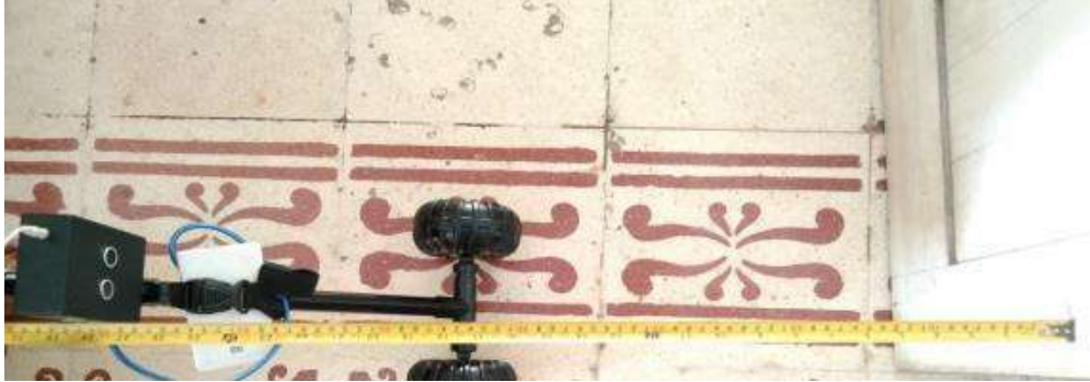
Gambar 9 Pengujian sensor depan jarak 70 cm
