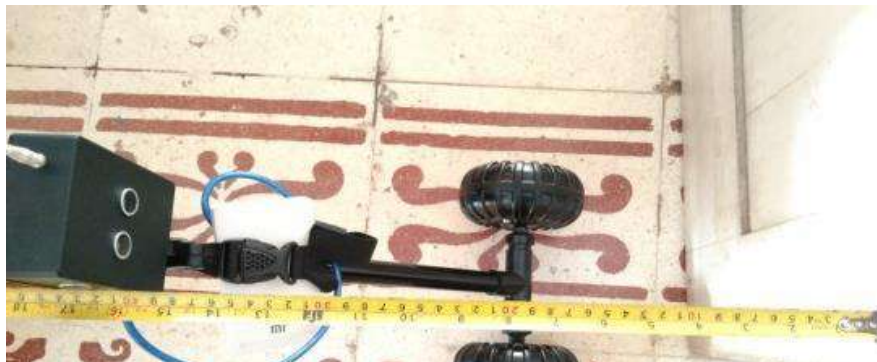
Gambar 8 Pengujian sensor depan jarak 40 cm
