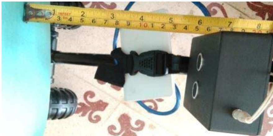
Gambar 7 Pengujian sensor depan jarak 15 cm
