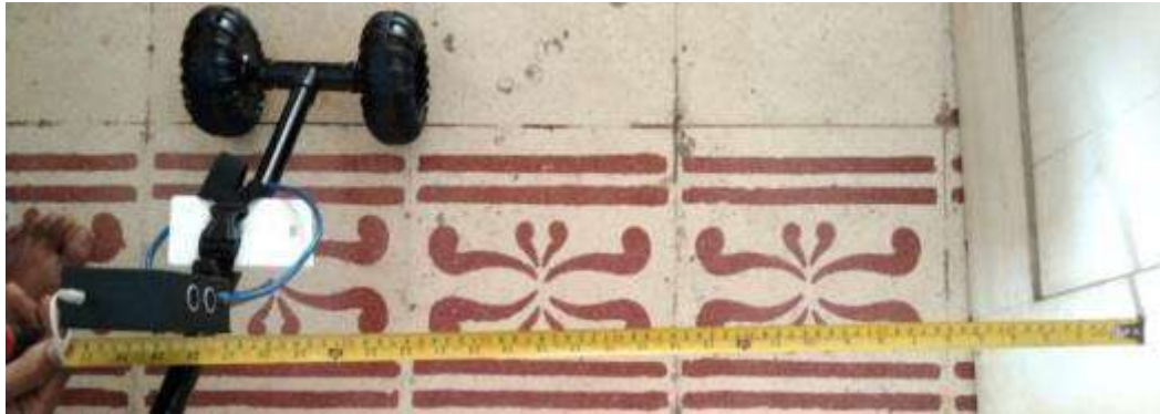
Gambar 12 Pengujian sensor kanan jarak 70 cm
