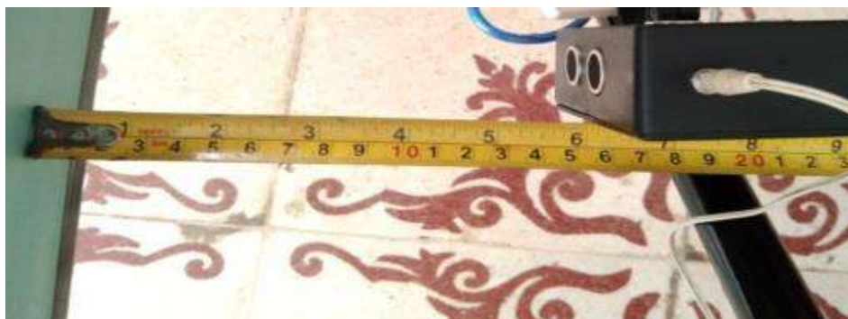
Gambar 13 Pengujian sensor kiri jarak 15 cm
