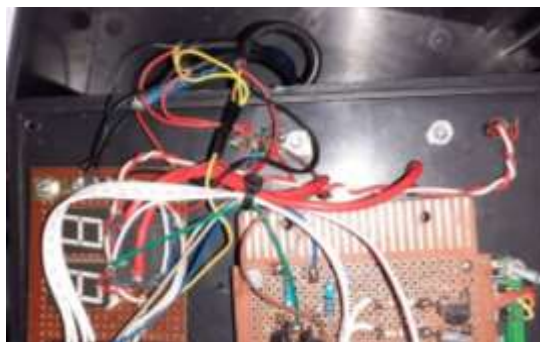
Gambar 5 Rangkaian Arduino Dengan DS18b20
