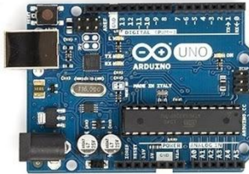
Gambar 2. Konfigurasi Pin Papan Sirkuit Arduino Uno [10]
