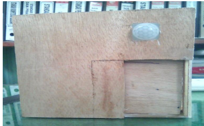
Gambar 14. Hasil alat Pintu Geser Aplikasi Arduino Uno
