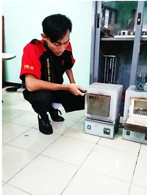
**Gambar 3.** Pemanasan Spesimen
