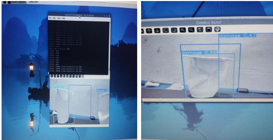
Gambar 3.3 (a) Gambar botol setelah memasuki ROI (b) Gambar servo bergerak mendorong botol rusak (Damage)
