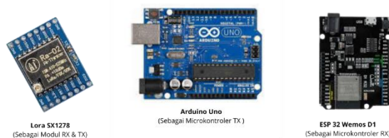
Gambar 3 komponen sensor & microcontroller yang di gunakan
