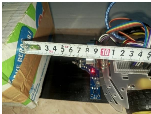
Gambar.7 Pengujian jarak sensor ultrasonic terhadap halangan.
