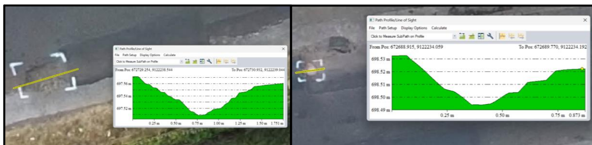
Gambar 5. Interpretasi visual kerusakan jalan jenis lubang.
