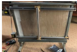
Gambar 11 Pemasangan Rell Atas dan Bawah
