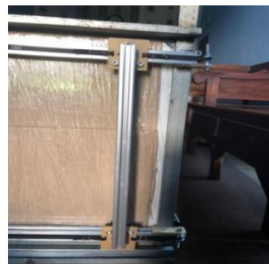
Gambar 12 pemasangan roda atas dan bawah
