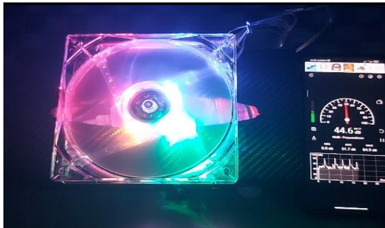
Gambar 11. Pengujian intensitas suara menggunakan sound meter satuan desibel.
