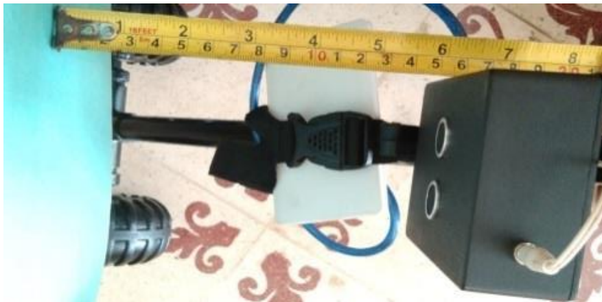
Gambar 7 Pengujian sensor depan jarak 15 cm
