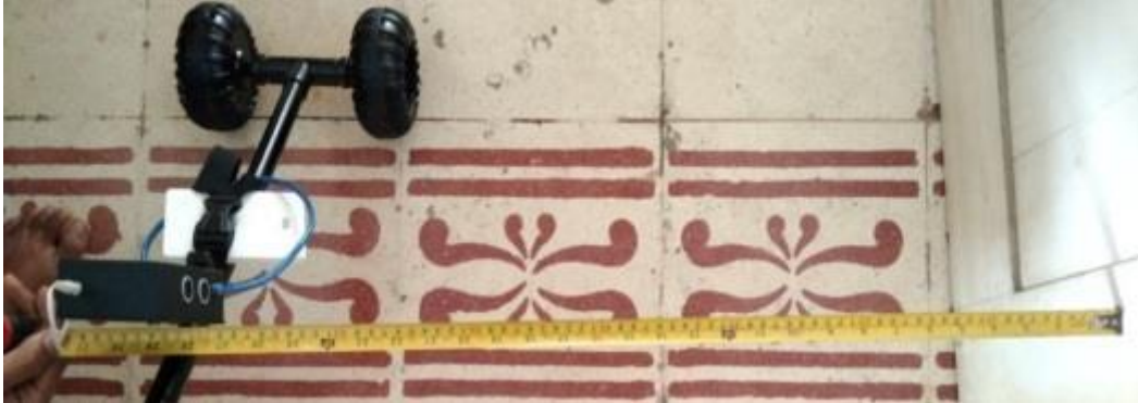
Gambar 12 Pengujian sensor kanan jarak 70 cm
