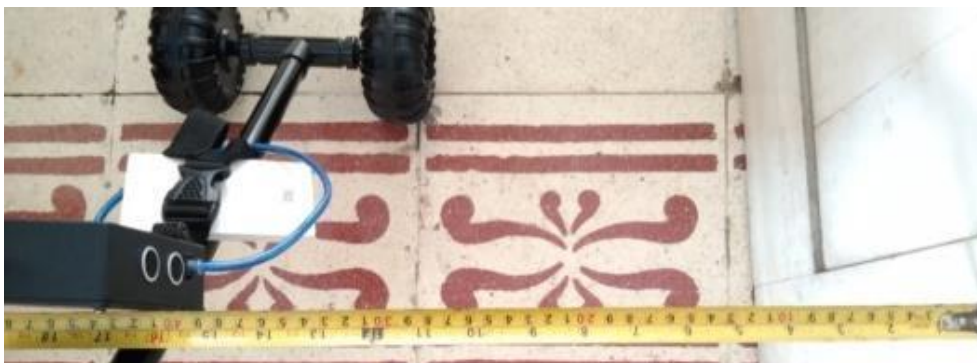
Gambar 11 Pengujian sensor kanan jarak 40 cm
