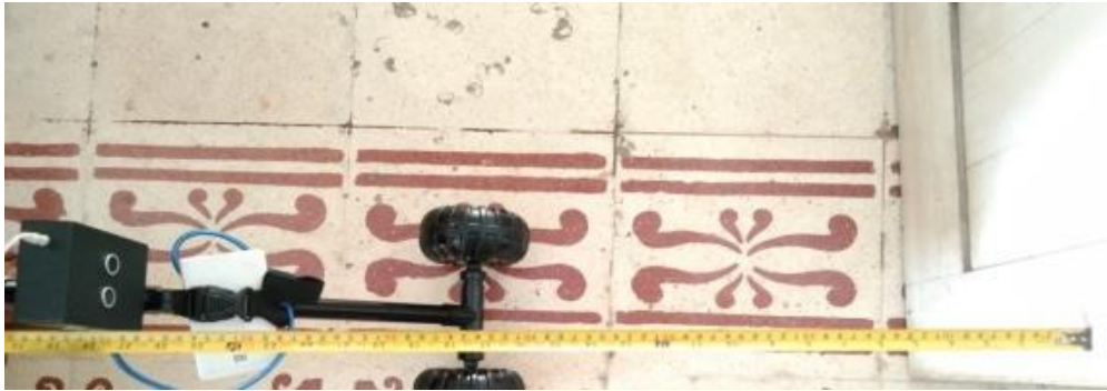
Gambar 9 Pengujian sensor depan jarak 70 cm
