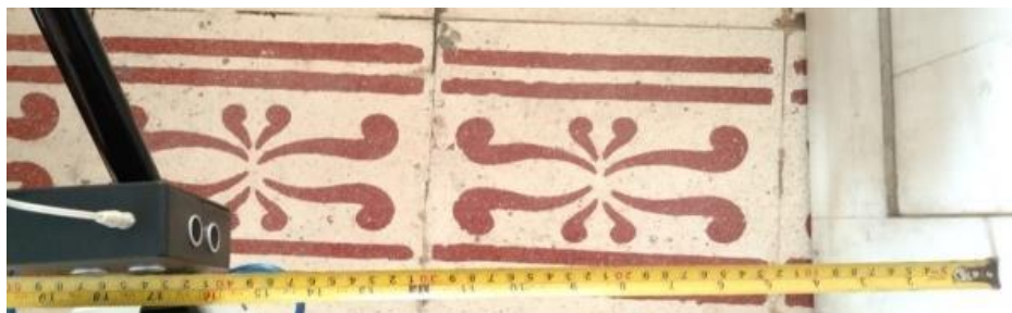
Gambar 14 Pengujian sensor kiri jarak 40 cm
