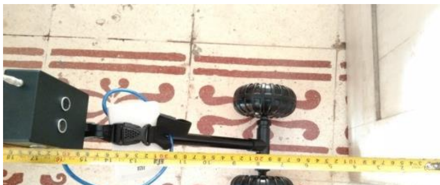
Gambar 8 Pengujian sensor depan jarak 40 cm
