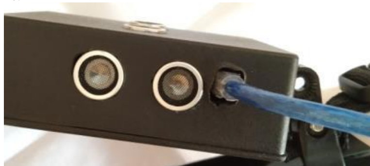
Gambar 3 Box sensor navigasi tuna netra samping kanan
