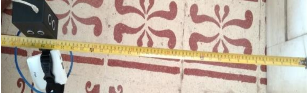
Gambar 15 Pengujian sensor kiri jarak 70 cm
