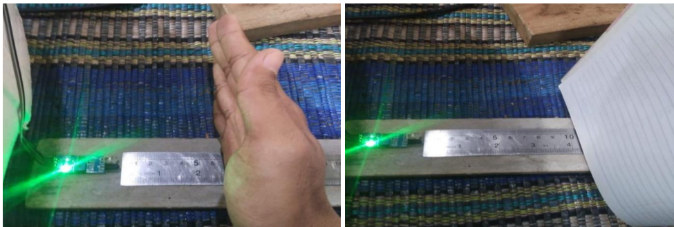
Gambar 12 Ujicoba Sensor IR Obstacle Avoidance Menggunakan Tangan dan Kertas
